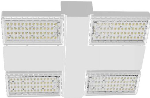
LED-Hallenleuchte für schwierige Anwendungen, modulare Bauweise, 4 Module inklusive LED-Konverter, elektronischem Vorschaltgerät, Gehäuse aus hochwertigem, korrosionsbeständigem Aluminiumdruckguss in Farbe weiß, Abdeckung aus PC mit exzellenter chemischen und UV-Beständigkeit für anspruchsvolle Industrieanwendungen, 190 lm/w Systemeffizienz, Schutzart IP65, Umgebungstemperatur: -20°C bis +70°C
